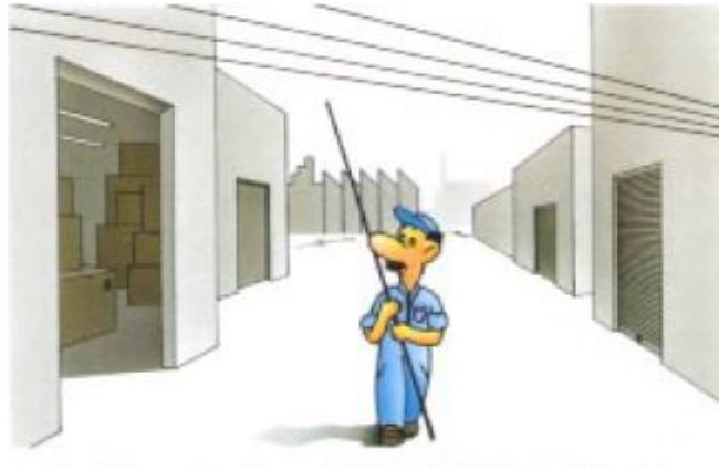
Cuidado con las líneas eléctricas. Mantén la distancia de seguridad.
