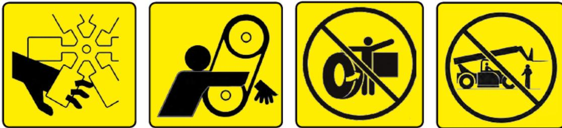
Manténgase alejado de los puntos de **aprimionamiento-aplastamiento** y de las piezas giratorias del manipulador telescópico.
