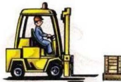
Acercarse, de forma perpendicular y centrada, hasta 30 cm del palet.
