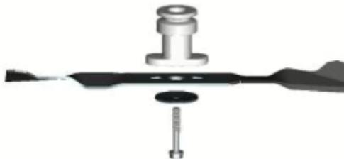
Vuelva a instalarla tal y como muestra el dibujo. Ajuste bien el tornillo. Par de apriete 45 Nm.
