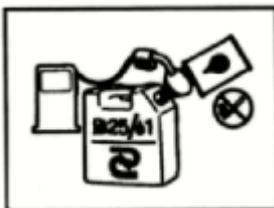
Mezcle una gasolina de grado normal (con plomo o sin plomo, sin alcohol) y un aceite de motor de calidad para refrigerar el motor de 2 ciclos.
