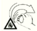
Colocar correctamente el cierre de aleta plegable (cierre de bayoneta), girarlo hasta el tope y plegar el estribo.
