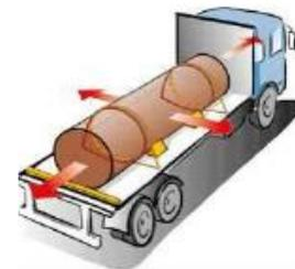
La suma de los efectos de cierre, bloqueo, estiba directa y por fricción se pueden utilizar para evitar que la carga se mueva, deslice, ruede, bascule, se deforme considerablemente o gire.
